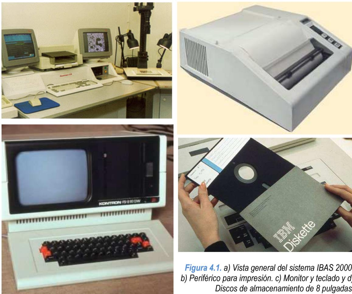
**Figura 4.1.** a) Vista general del sistema IBAS 2000, b) Periférico para impresión. c) Monitor y teclado y d) Discos de almacenamiento de 8 pulgadas.
